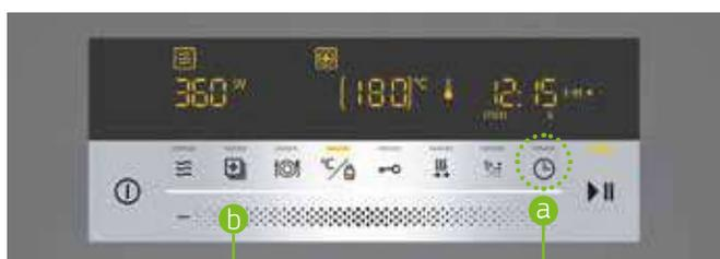
Los sensores del control Deslizante permiten modificar los ajustes básicos
